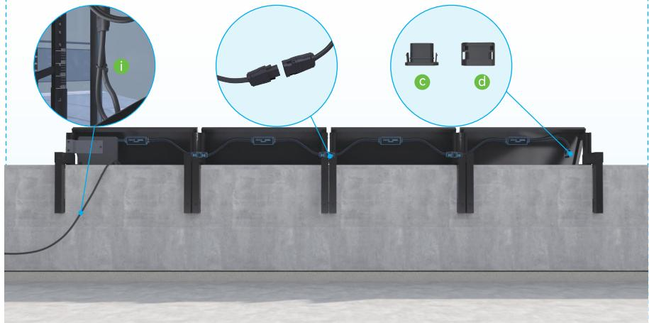
1. Verbinden Sie die Kabel zwischen den Modulen
