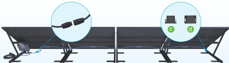
1. Verbinden Sie die Kabel zwischen den Modulen
