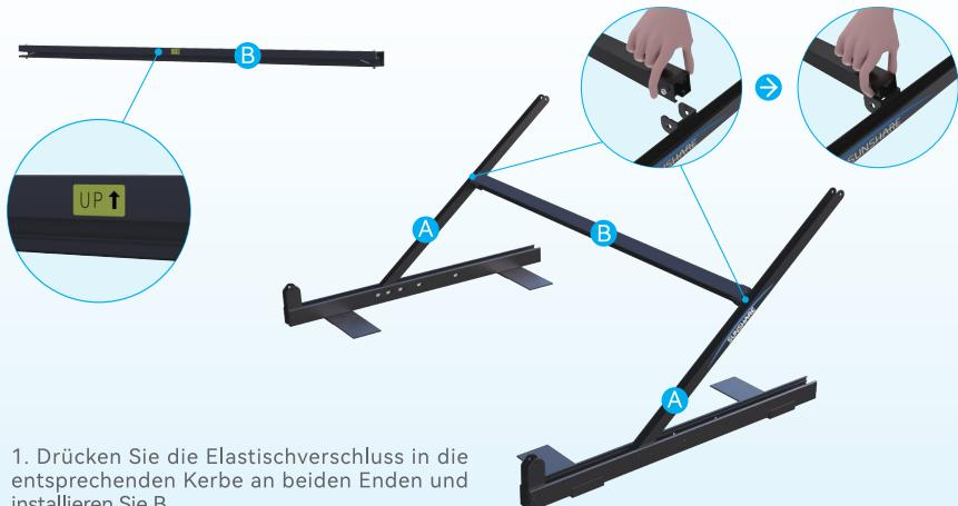
1. Drücken Sie die Elastischverschluss in die entsprechenden Kerbe an beiden Enden und installieren Sie B
